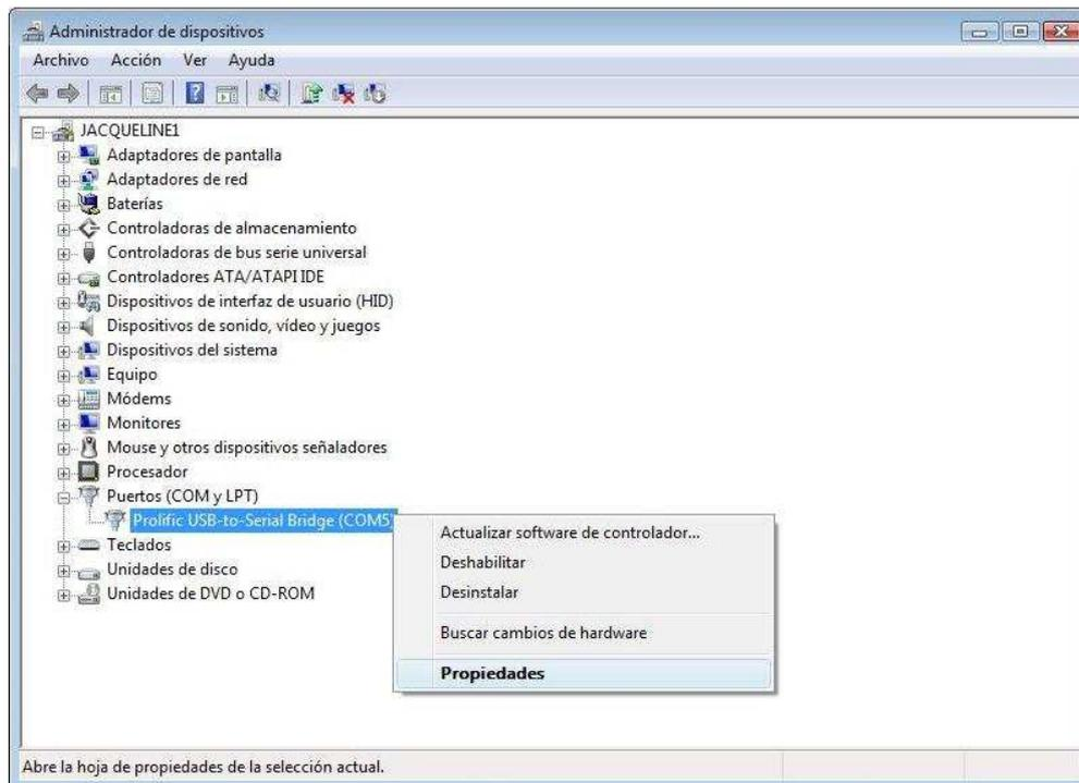
Desplegando la opción Puertos (COM y LPT) se podrá ver el adaptador (este debe haber sido instalado previamente según las indicaciones de cada fabricante).
